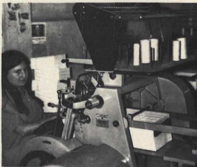
automática o semi-automática, que va uniendo los diferentes pliegos con hilo vegetal hasta darles una sujeción a todos los que componen el libro.
